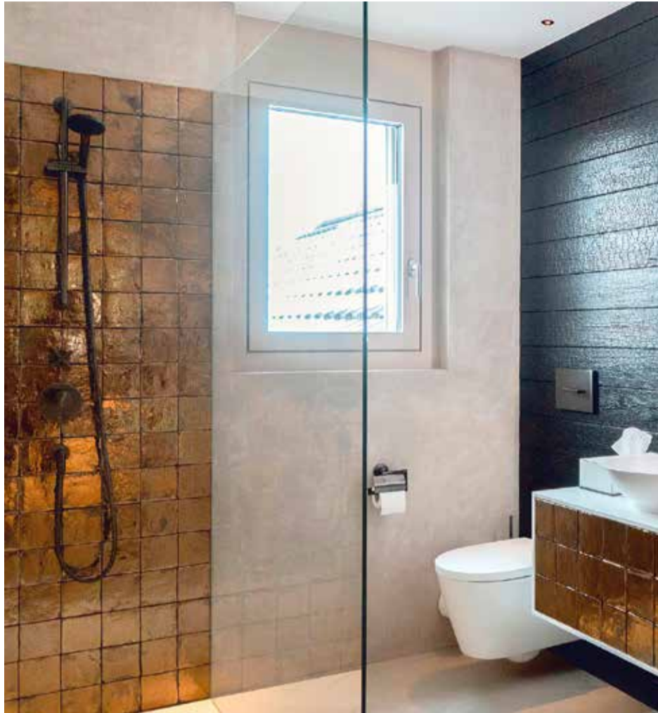
Nachher: Das neu schwellenlose Badezimmer ohne Kanten und Stolpersteine erhöht den Komfort und die Sicherheit.
