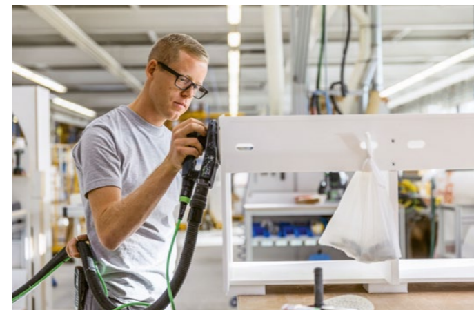
Letzter Schliff der Möbelaussenseite vor der Endkontrolle.
