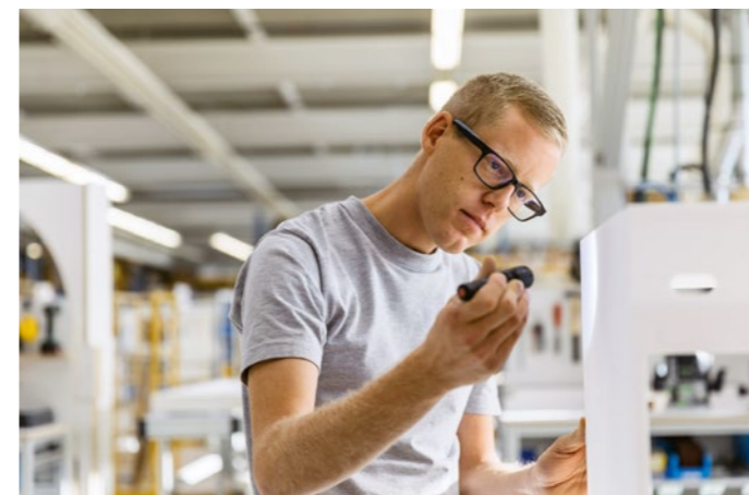
Mittels Lichtstrahl wird bei der Endkontrolle die Corian-Oberfläche auf Unebenheiten geprüft.
