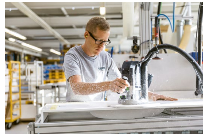
Der Produktionsmitarbeiter in der Corian-Verarbeitung von Dyson fräst den Plattenüberstand bündig.
